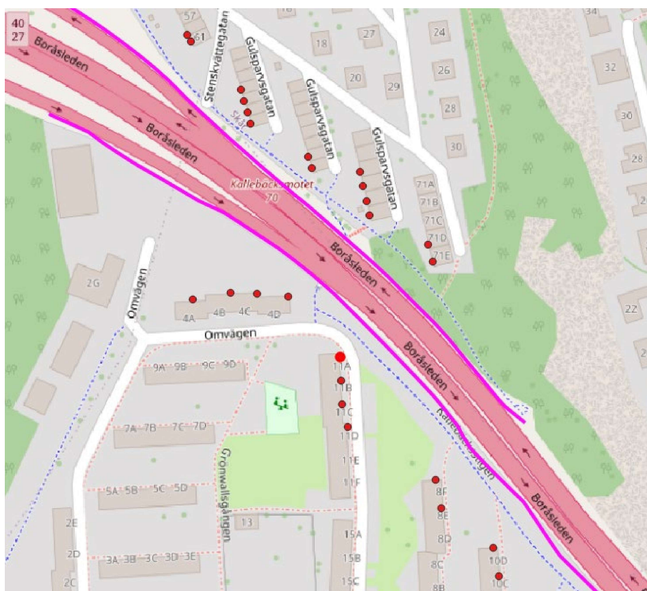
Figur 7 Bostäder med en ekvivalent bullernivå över 65 dBA trots bullerskärm längs med Boråsleden
